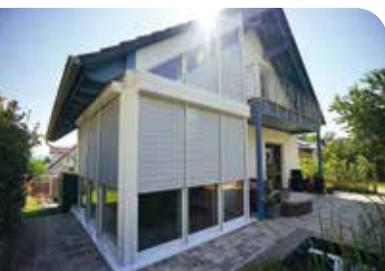
Der Rollladenkasten lässt sich einfach und nachträglich an der Hausfassade oder am Fensterrahmen befestigen. Der Platzbedarf ist relativ gering. Selbst wenn die Lamellen lackiert sind, genügt für einen 3,50 Meter hohen Rollladen ein Kasten von je 16,5 Zentimetern Höhe und Tiefe.
